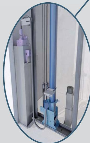
Détail de l'installation du réservoir dans la cuvette.
